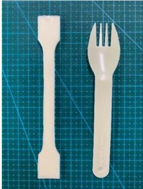
抗菌性を持つバイオマス系生分解性樹脂のダンベル試験片と簡易的成形品
